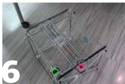
► Обведенные кружками двигатели перемещают печатающую головку в направлении стрелок, имеющих тот же цвет
